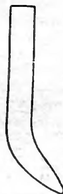
Рис. 7. Стальная изогнутая игла для проигрывания желатиновых и целлулоидных пластинок
