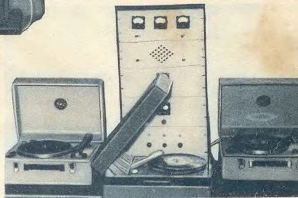
Трехпрограммная установка для вещания по проводам (Харьковский техникум связи)
