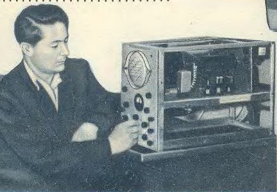
Старший лаборант Куперман Р. Б. у электронного прибора ЭИС-1 для измерения искажений сигналов стартостных аппаратов (Киевский политехникум связи)
