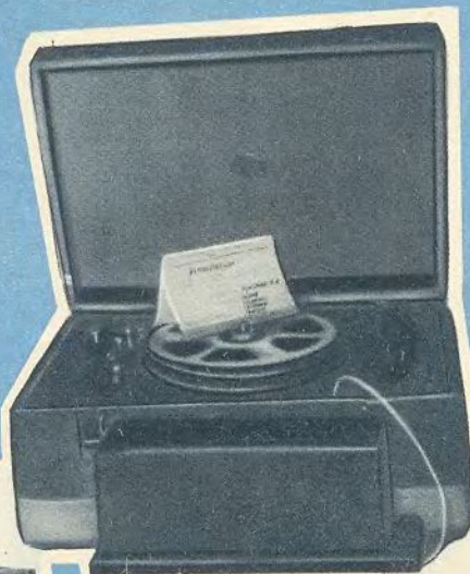
Автоответчик, позволяет в отсутствие абонента ответить по телефону и записать на пленку телефонный разговор. Сконструирован в Московском политехникуме связи
