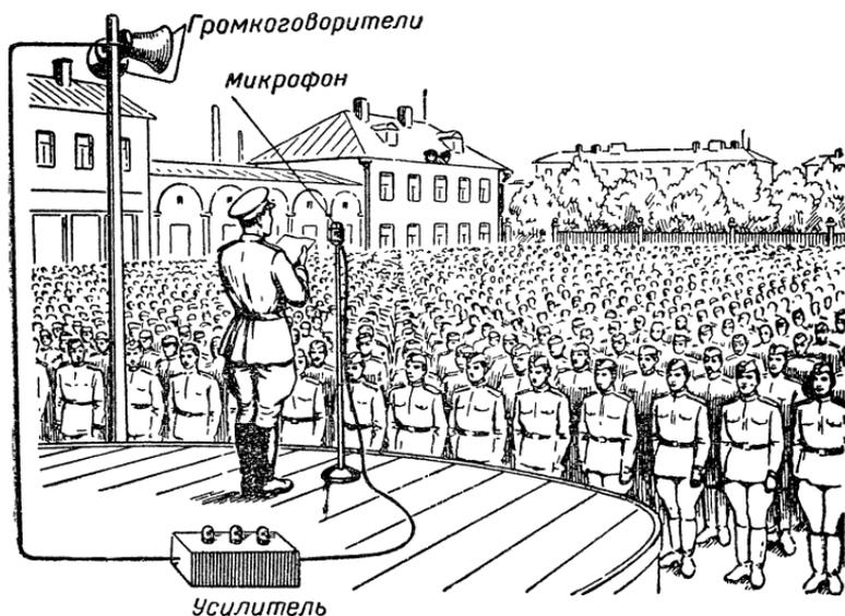
Рис. 7. Электрическая передача и усиление звука.
