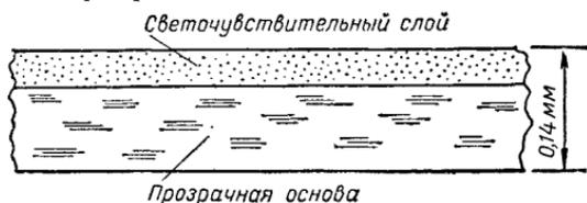
Рис. 23. Строение светочувствительной пленки в разрезе.
