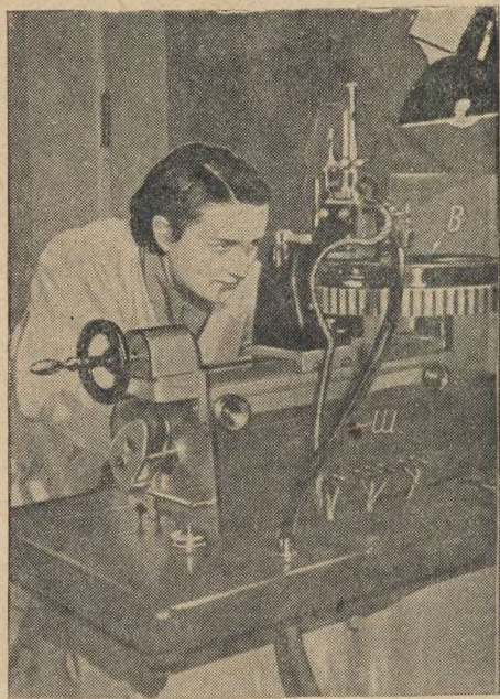
Рис. 8. Звукозаписывающий станок. в — восковой диск; ш — шланг для отсоса стружки
