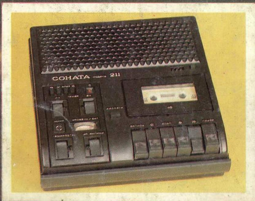
С ПОМОЩЬЮ КЛАВИШИ «ПАУЗА» МОЖНО ПРОПУСТИТЬ ФРАГМЕНТ ЗАПИСЫВАЕМОЙ ПРОГРАММЫ. МАГНИТОФОН СНАБЖЕН ПЕРЕКЛЮЧАТЕЛЕМ ТИПА ЛЕНТЫ, ВЫДВИЖНОЙ РУЧКОЙ ДЛЯ ПЕРЕНОСА.
