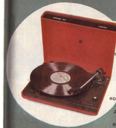
Электропроигрыватель «Импульс-201-стерео» работает в комплекте с любым радиоаппаратом, имеющим усилительное устройство: магнитофоном, радиоприемником, стереофоническим усилителем, снабженными акустической системой, и др. «Импульс» имеет регулятор частоты вращения диска, автостоп, микролифт, регулятор прижимной силы, компенсатор скользящей силы. Применение сверхтихоходного двигателя и магнитной головки ГЗМ-103 с алмазной иглой обеспечивает высокое качество воспроизведения грамзаписи.
