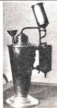
На фото: аппарат для перегонки розового масла (изобретение И. В. Мичурина)
