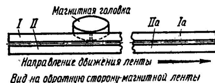
Рис. 3. Порядок записи звуковых дорожек при двухдорожечной записи с взаимнопротивоположным направлением дорожек, I — дорожка № 1 — конец; II — дорожка № 2 — начало; Iа — дорожка № 1 — начало; IIа — дорожка № 2 — конец
