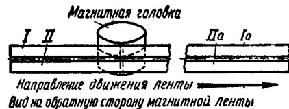
Рис. 4. Порядок записи звуковых дорожек при стереофонической записи: I — левый канал — конец; II — правый канал — конец; Iа — левый канал — начало; IIа — правый канал — начало
